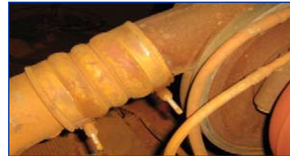
Figura 5: Exemplo da mangueira entre o turbo compressor e o aftercooler que se desprendeu
