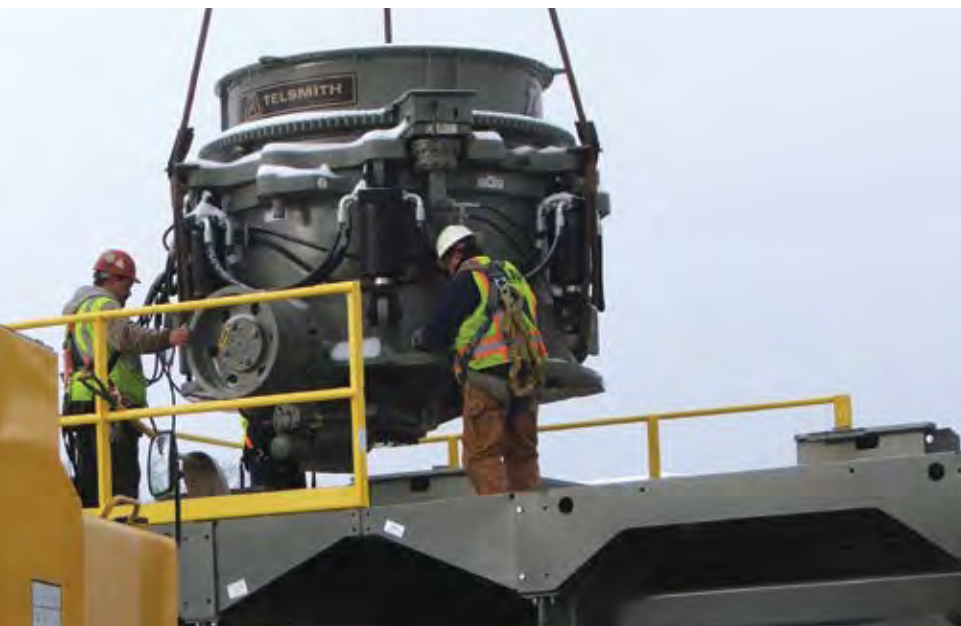
Los chancadores de la serie Titan de Telsmith, incluyendo el nuevo T900, probados en aplicaciones de agregados de construcción, están diseñados para impulsar la empresa mucho más en el área de la minería. (Foto: Telsmith)
