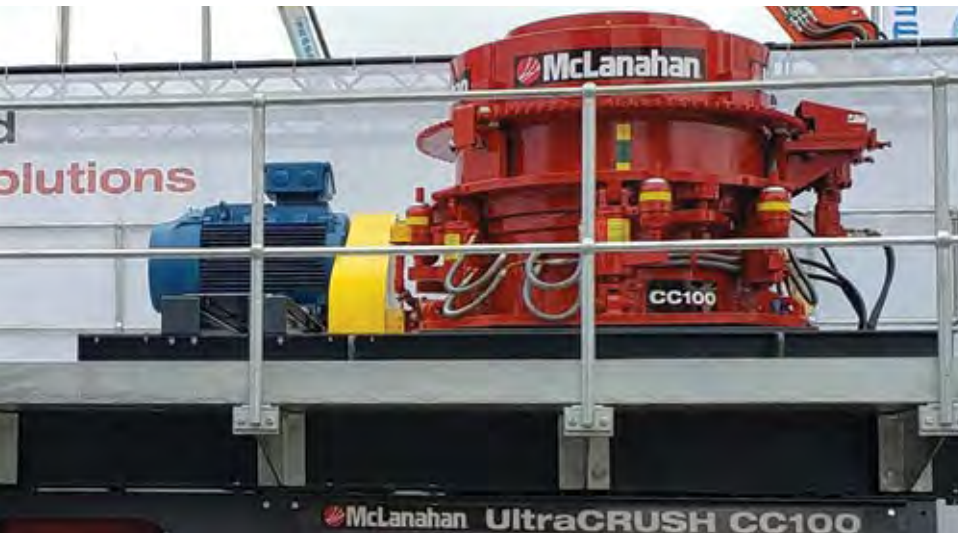
McLanahan lanzó el chancador de cono nuevo, transportable, modular UltraCRUSH en Bauma en el 2019. (Foto: McLanahan)
